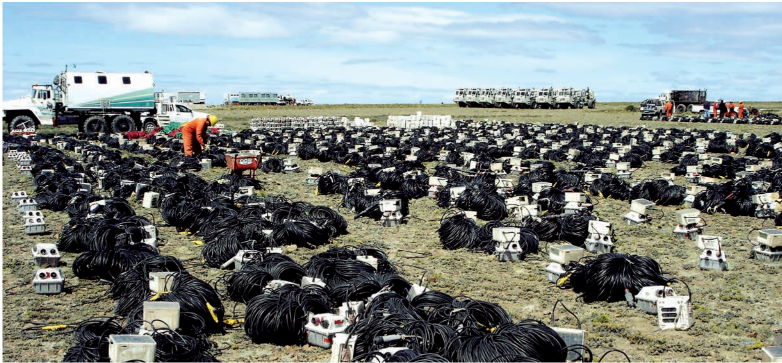
Arriba: los exploradores recorren extensas áreas, muchas son de difícil acceso y parte de los trayectos se transitan a caballo. Abajo: preparación de geófonos para un relevamiento de sísmica.
