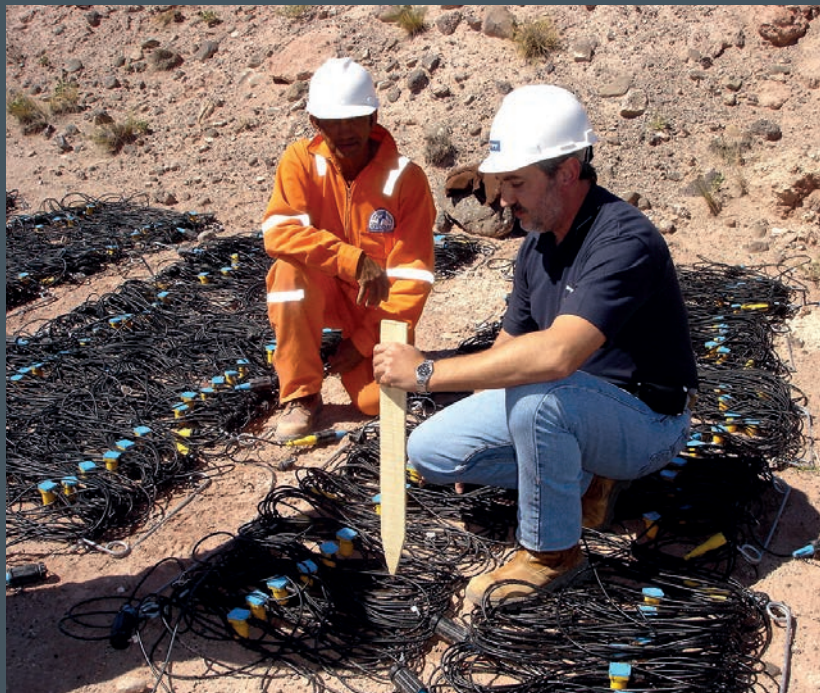
Arriba: plegamiento de las pelitas de la Formación Los Monos (roca generadora) en la serranía del Aguaragüe, departamento de Tarija, en el extremo sur de Bolivia. Abajo: preparación de los geófonos para estudios geofísicos del subsuelo.
